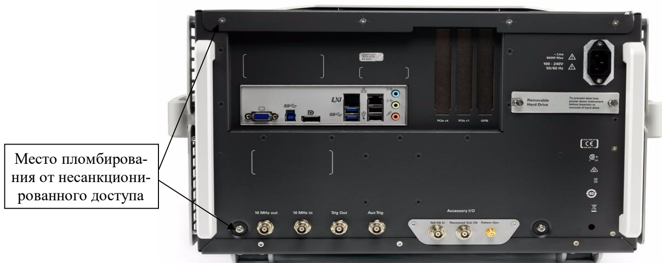
Рисунок 2 - Схема пломбировки от несанкционированного доступа Осциллографы могут иметь опции, приведённые в таблице 1.
