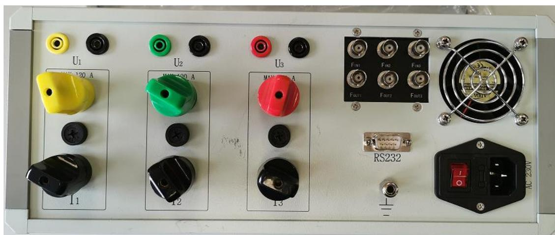
Рисунок 2 – Задняя панель прибора электроизмерительного многофункционального HEBA-Тест 5320
