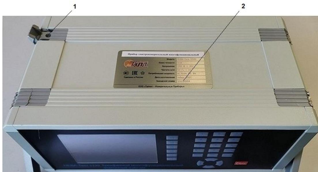
Рисунок 3 – Верхняя панель прибора электроизмерительного многофункционального HEBA-Тест 5320, обозначение места нанесения знака поверки от несанкционированного доступа (1) и место нанесения заводского номера (2).
