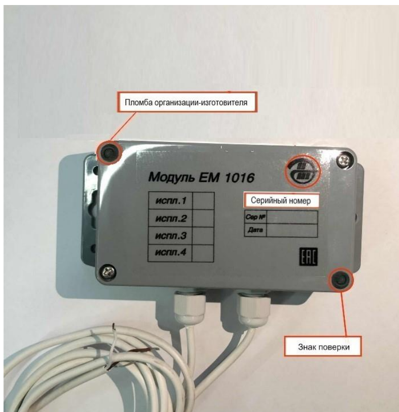
Рисунок 2 – Схема пломбировки модуля от несанкционированного доступа. Место расположения серийного номера и знака поверки модуля
