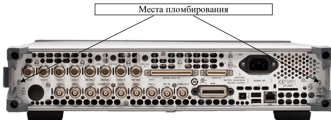
Рисунок 2 – Схема пломбировки генератора N5166B
