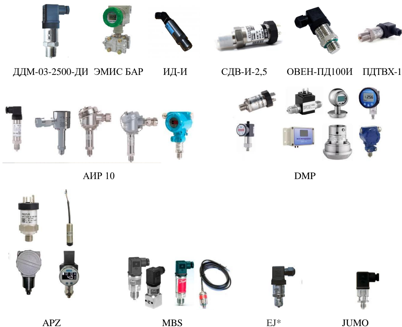
Рисунок 6 – Общий вид и наименование СИ избыточного давления
