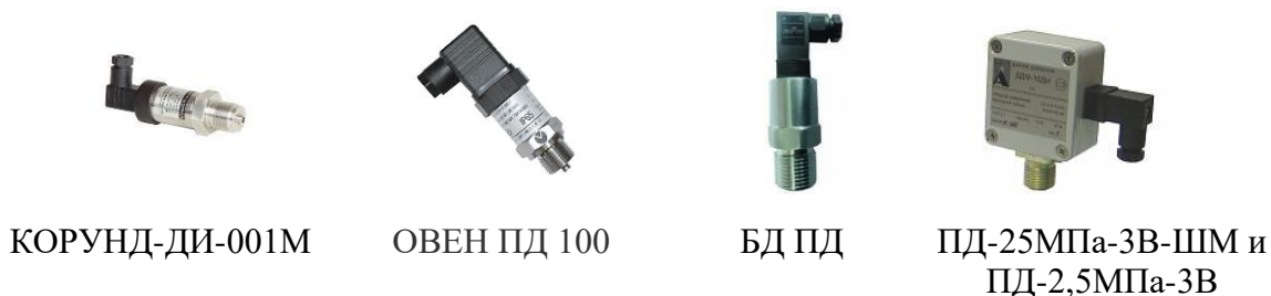
Рисунок 7 – Общий вид и наименование СИ избыточного давления
