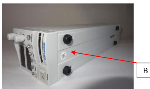
Рисунок 2 – Вид задней панели источников, место пломбировки от несанкционированного доступа (В)
