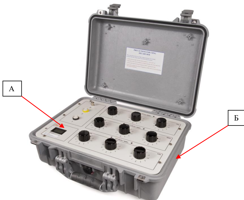
Рисунок 1 – Общий вид мер АКИП-7516/1, АКИП-7516/2, АКИП-7516/3, АКИП-7516/4, АКИП-7516/5, места нанесения знака утверждения типа (А) и знака поверки (Б)
