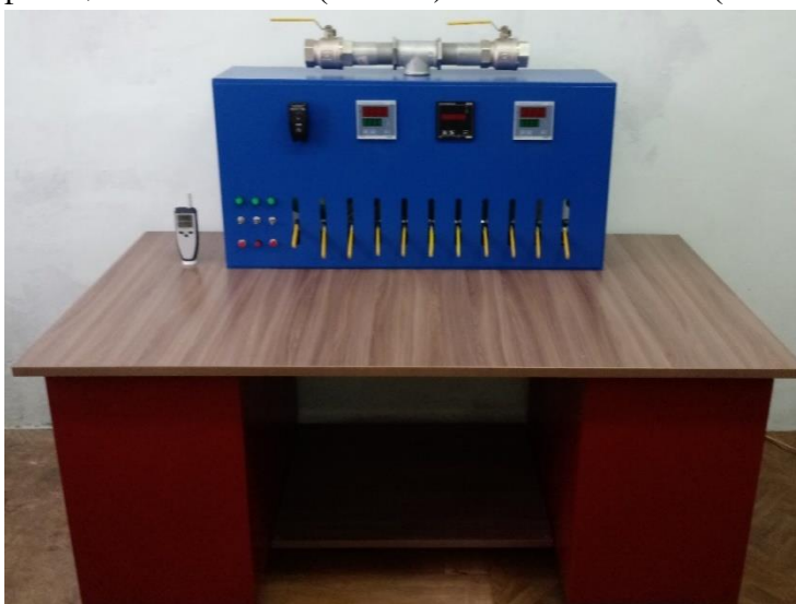
Рисунок 3 – Общий вид установок поверочных для счетчиков газа «УПСГ-КС» модификаций «УПСГ-КС-(65...160)-Р» и «УПСГ-КС-(65...160)-А»
