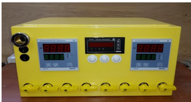
Рисунок 1 – Общий вид установок поверочных для счетчиков газа «УПСГ-КС» модификаций «УПСГ-КС-(6...10) Р»
