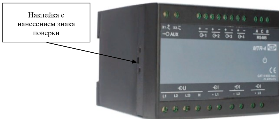
Рисунок 1 - Общий вид преобразователей с указанием места ограничения доступа к местам настройки (регулировки)
