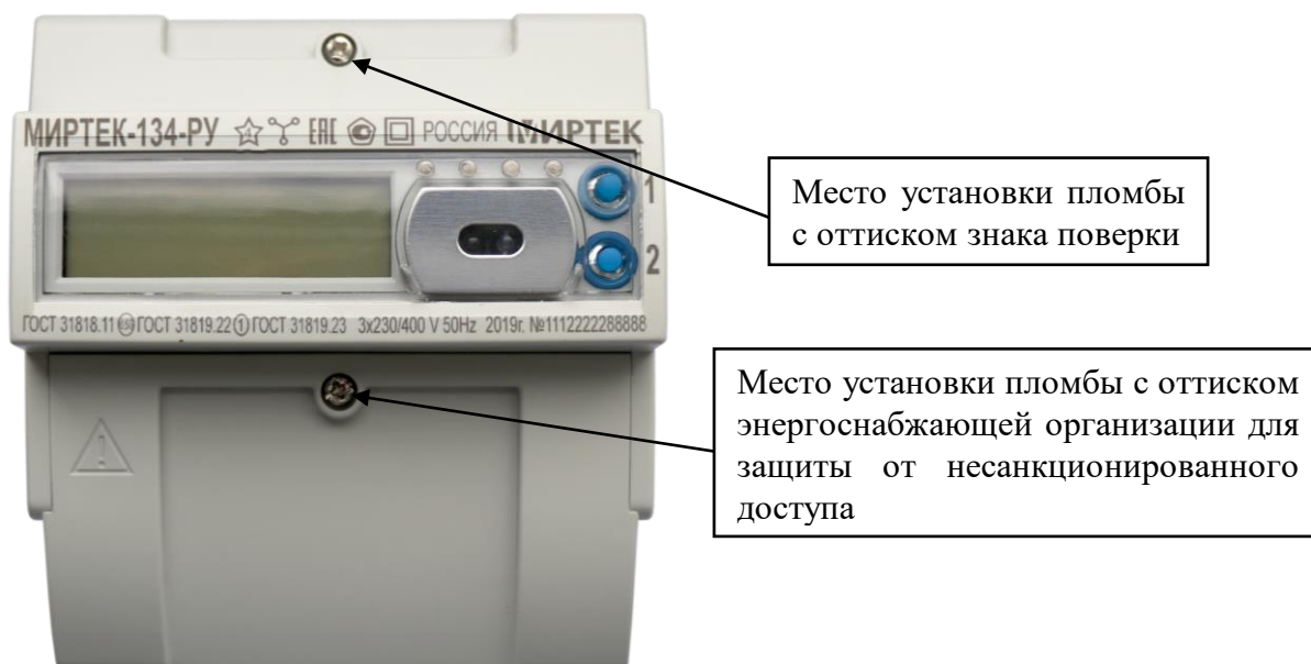
Рисунок 2 – Общий вид измерителя в корпусном исполнении D33.1
