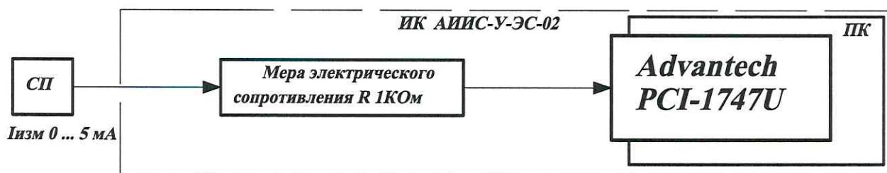
Рисунок 10.11 – Схема определения МХ ИК влажности воздуха или температуры (в точки влажности воздуха)
