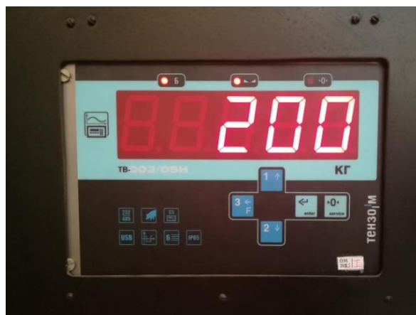
Рисунок 6 – Преобразователь весоизмерительный ТВ-003/05Д. Монтаж по месту
