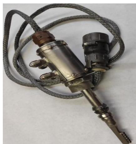
Рисунок 16 – Комбинированная гребёнка П.2541.000-1 на 6 ТП с НСХ ТХК(L). В качестве примера одного из вариантов монтажа
