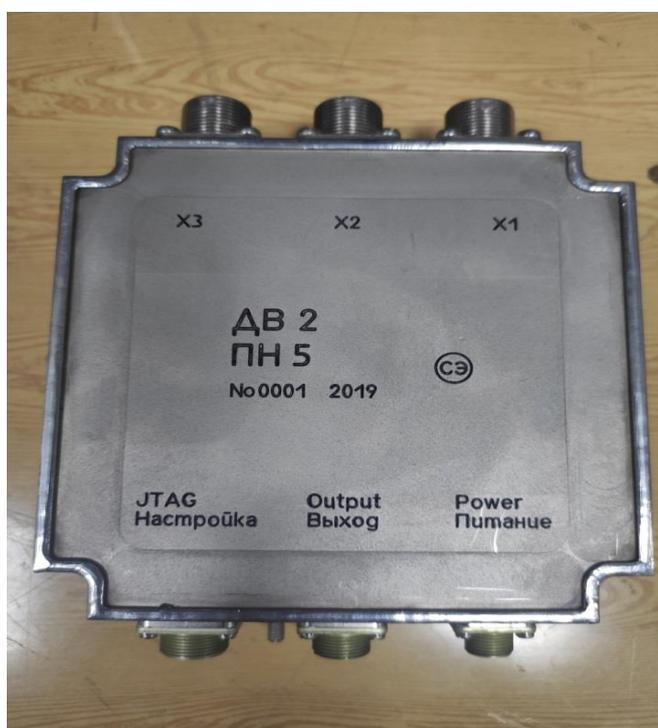
Рисунок 2 – Общий вид вторичного преобразователя ПН 5.
