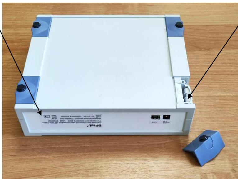
Рисунок 3 - Места нанесения знака поверки, знака утверждения типа
