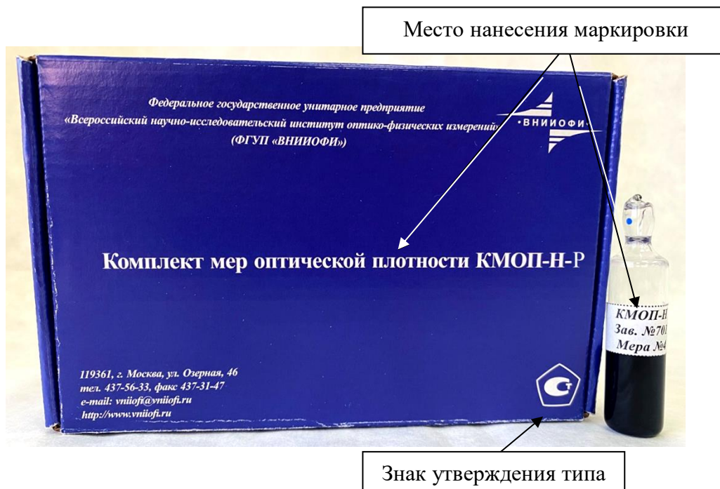
Рисунок 1 - Общий вид комплекта мер оптической плотности КМОП-Н-Р исполнения 1
