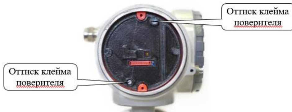
Рисунок 4 – Места нанесения знака поверки на ИП расходомера-счётчика Питерфлоу Т модификации 3
