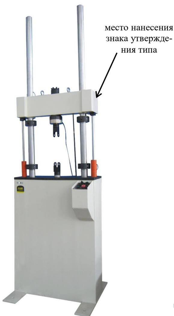
Рисунок 2 – Общий вид машин универсальных ТРМЦ Tochline с номинальными нагрузками до 300 кН
