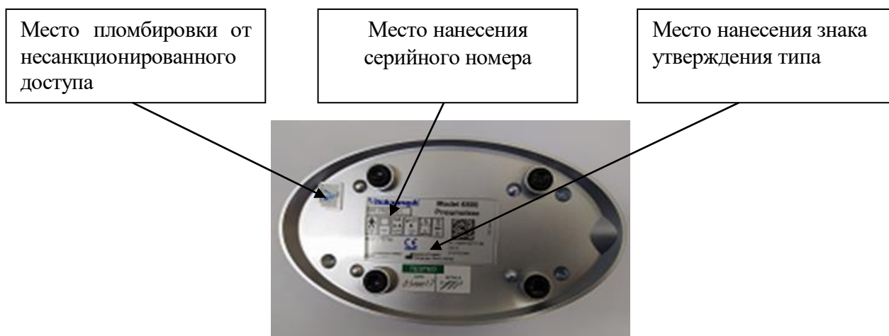
Рисунок 2 – Схема пломбировки от несанкционированного доступа, место нанесения знака утверждения типа и место нанесения серийного номера
