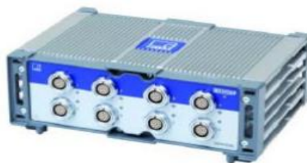
Рисунок 4 – Общий вид подсистемы НДС
