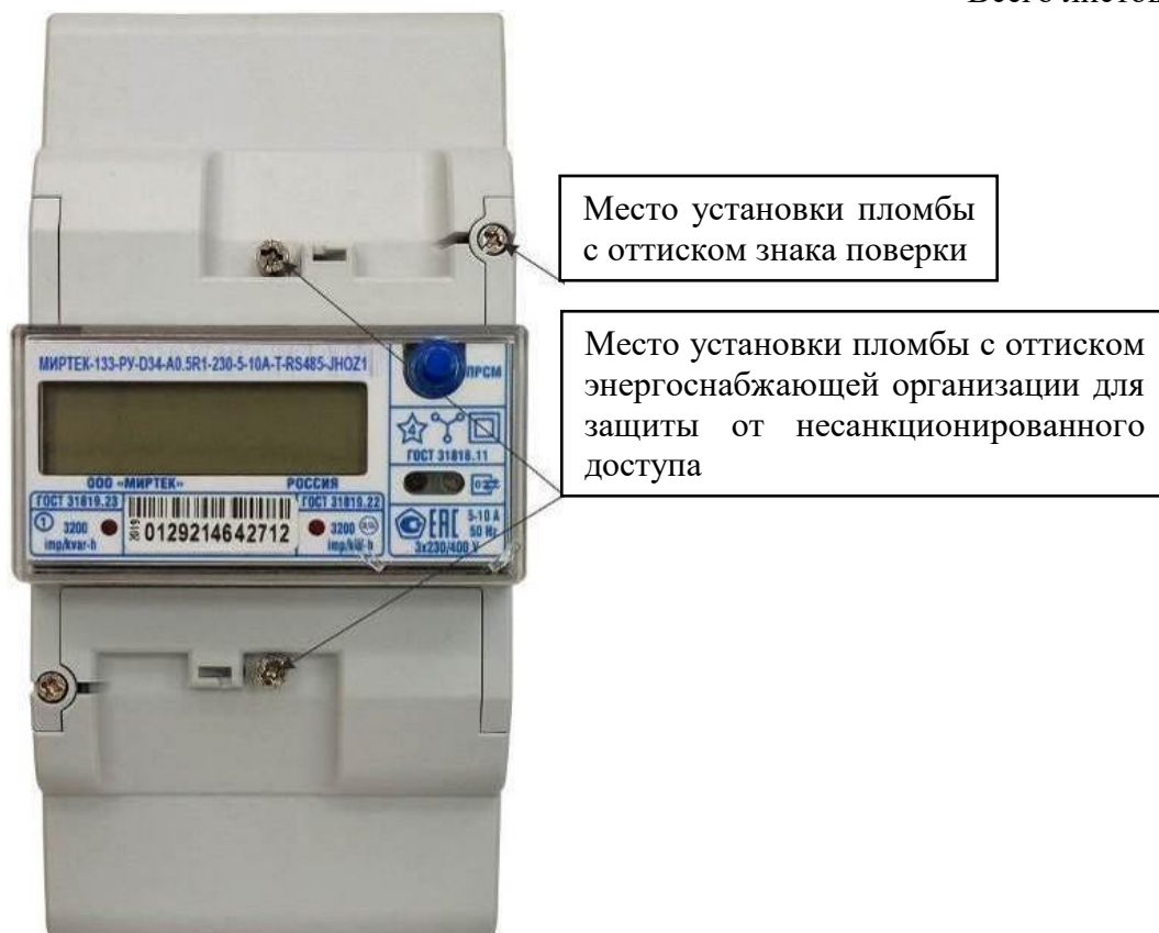
Рисунок 6 – Общий вид счетчика в корпусе типа D34 с символом «J» в условном обозначении
