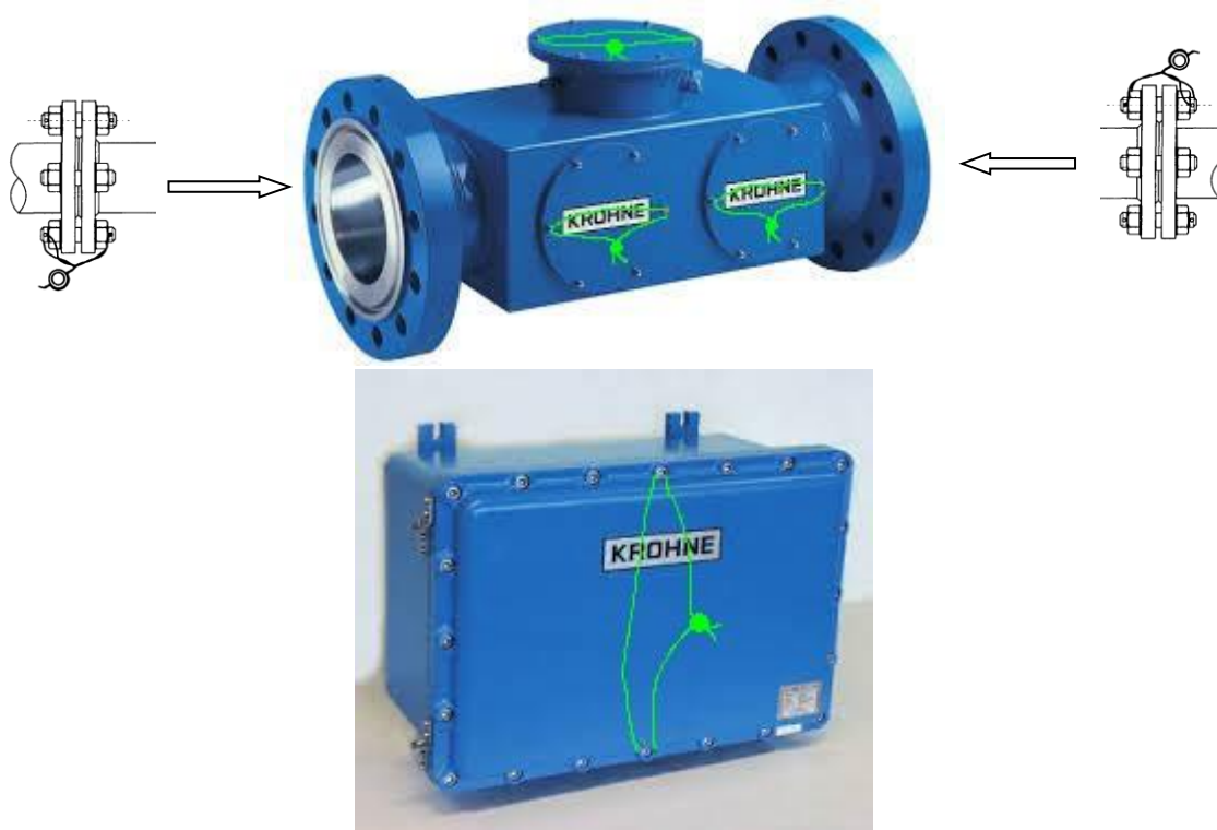
Рисунок 1 – Схема пломбировки от несанкционированного доступа ПР
