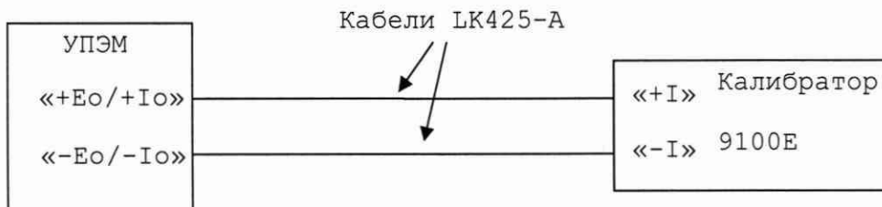
Рисунок Г.3 - Схема для калибровки измерителя силы постоянного и переменного тока
