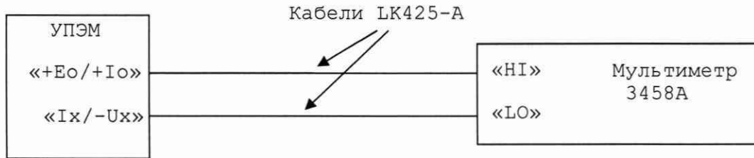
Рисунок Г.1 - Схема для калибровки источника напряжения постоянного и переменного тока
