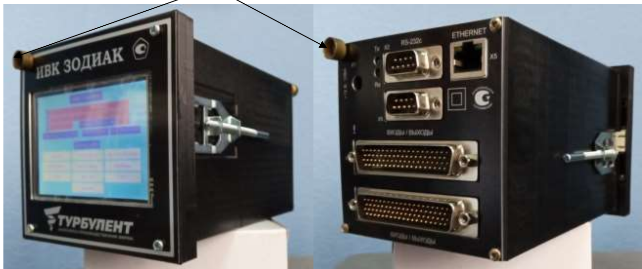
Рисунок Б.1 – Схема пломбировки от несанкционированного доступа, обозначение места нанесения знака поверки
