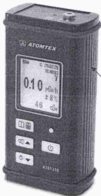
Рисунок 2 – Место нанесения знака поверки (клейма-наклейки)
