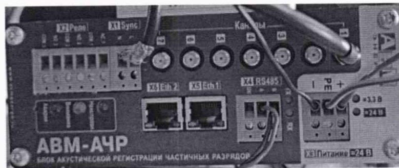
Рисунок 2 – Внешний вид блока после сборки схемы поверки
