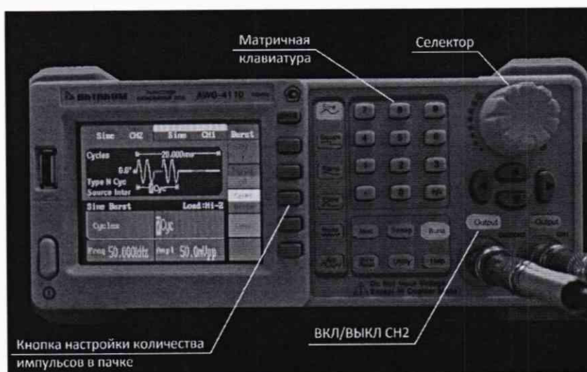
Рисунок 16 – Настройка режима выдачи пачек импульсов (ч.2)
