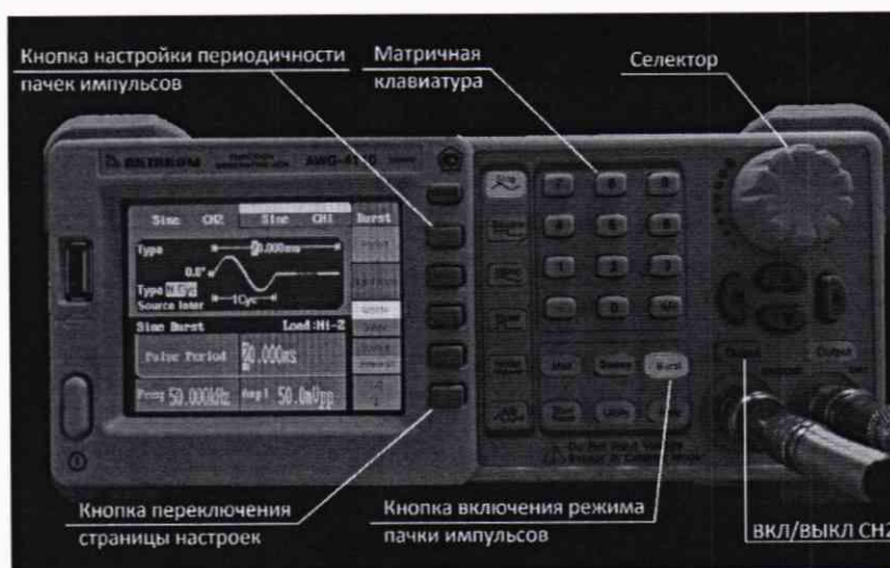
Рисунок 15 – Настройка режима выдачи пачек импульсов (ч.1)
