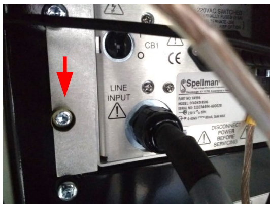
Чашка для пломбирования на задней панели ВИП
