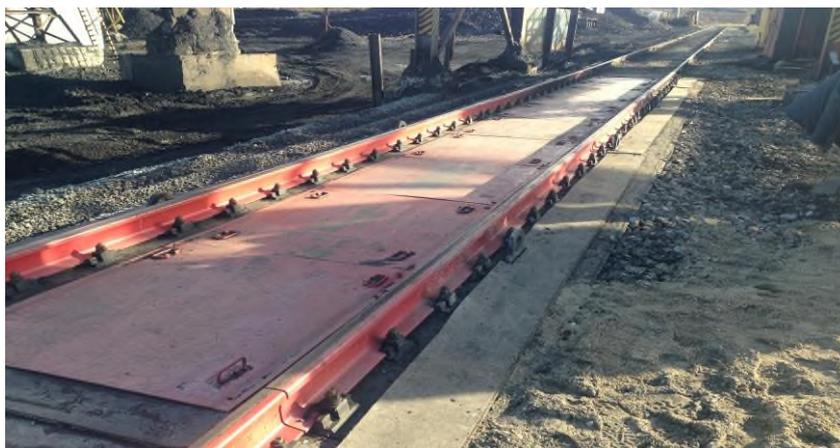
Рисунок 1 – Общий вид ГПУ весов, установленных на фундаментное основание.
