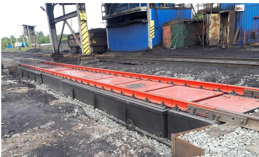
Рисунок 2 - Общий вид ГПУ весов, установленных на щебеночное основание.
