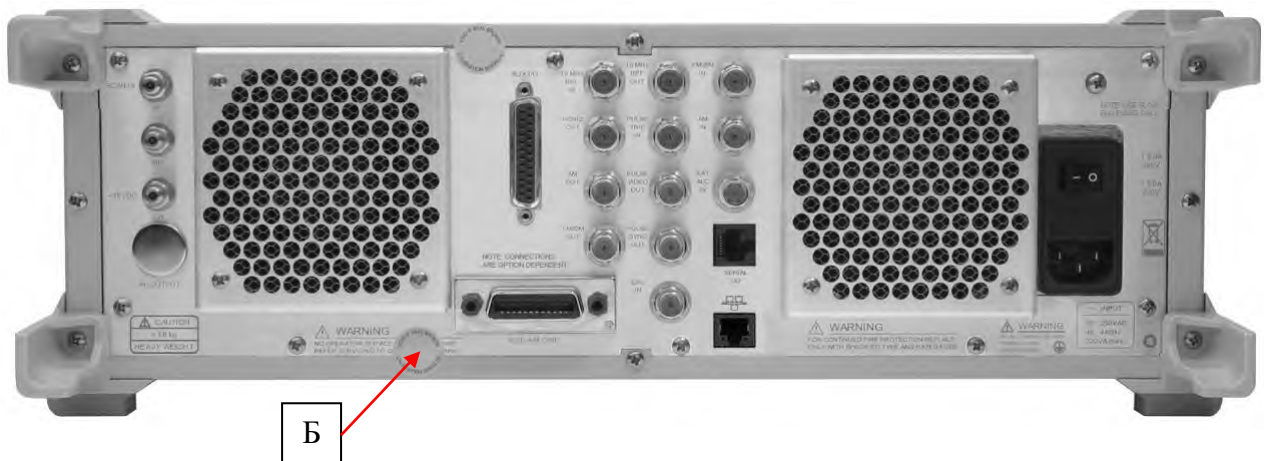
Рисунок 2 – Схема пломбировки от несанкционированного доступа (Б)
