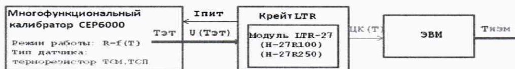
Рисунок 8.3 – Функциональная схема поверки МИТ с терморезистором
