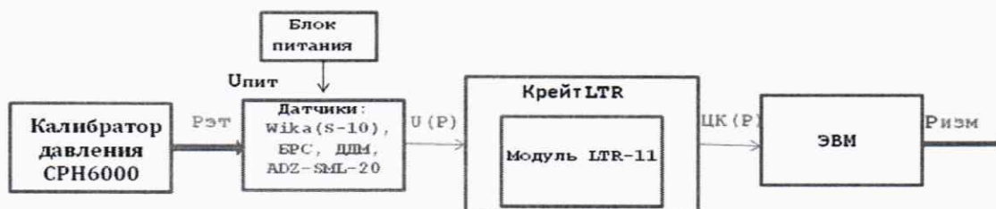
Рисунок 8.1 – Функциональная схема поверки МИД для датчиков с вольтовым выходом
