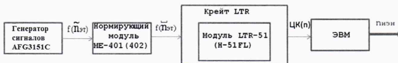
Рисунок 8.7 – Функциональная схема поверки МИЧВР
