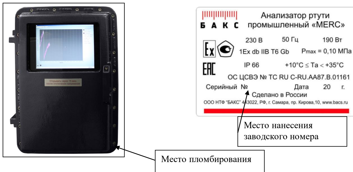
Рисунок 1 – Общий вид анализатора ртути промышленного «MERC» и вид шильды
