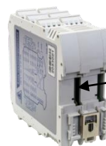
Рисунок 2 – Схемы пломбировки весов от несанкционированного доступа к УОАД
