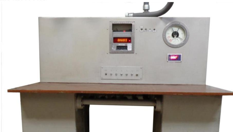
Рисунок 1 – Общий вид установки поверочной для счетчиков газа УПС-7.5.
