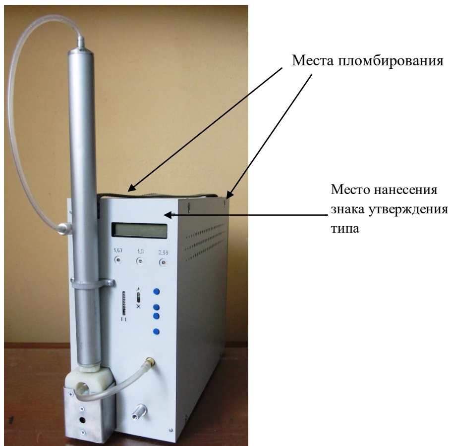
Рисунок 1 - Общий вид спектрометров и схема пломбировки от несанкционированного доступа
