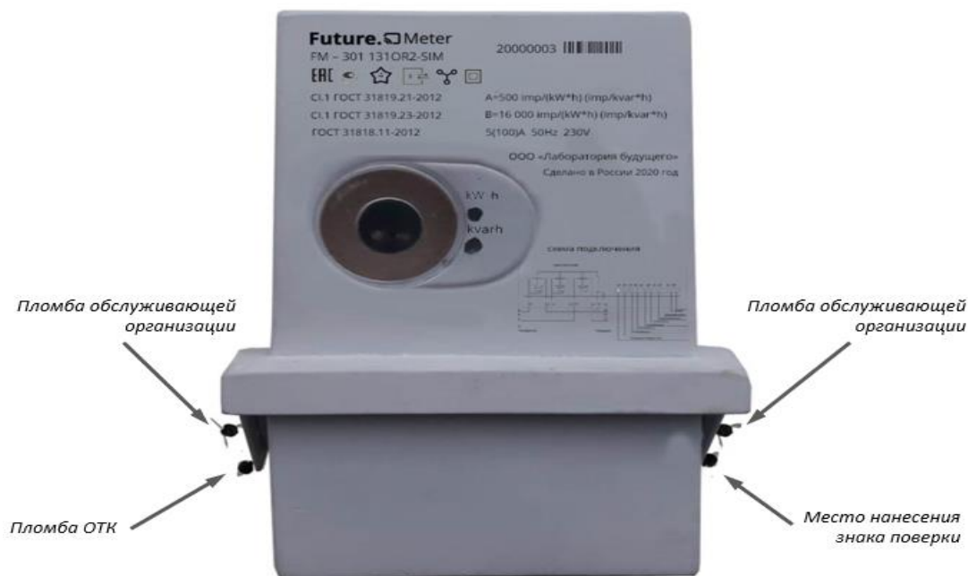
Рисунок 2 – Общий вид счетчика наружной установки, схема пломбирования от несанкционированного доступа, обозначение места нанесения знака поверки.
