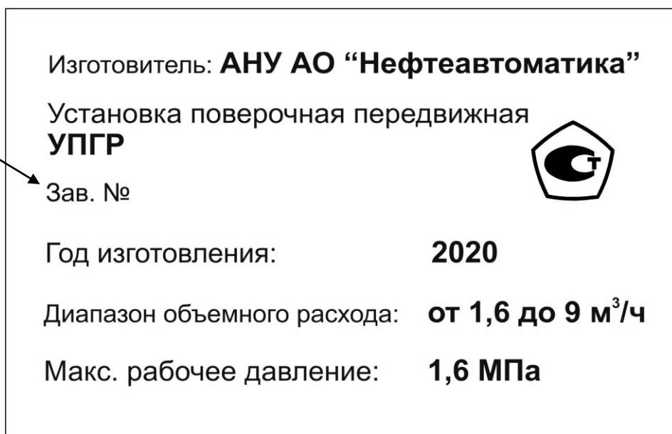
Рисунок 3 – Схема нанесения заводского номера на установку
