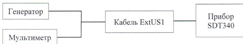
Рисунок 2 – Схема соединений при определении основной относительной погрешности измерений переменного напряжения с использованием кабеля ExtUS1
