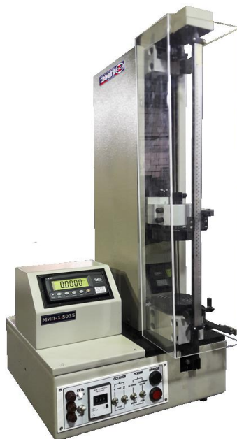
Рисунок 1 – Общий вид машин для испытания пружин МИП-1 5035
