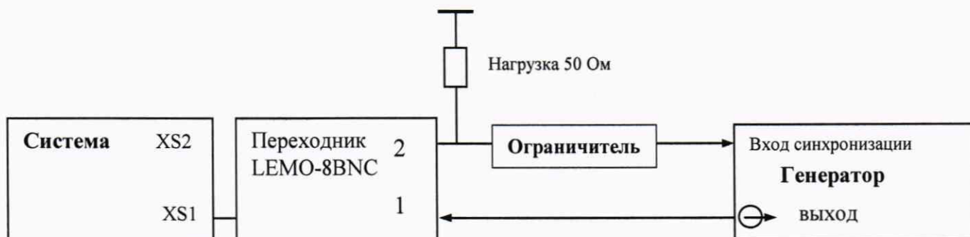
Рисунок 2 – Схема соединения для определения абсолютной погрешности измерений длительности временных интервалов для каналов фазированных решеток
