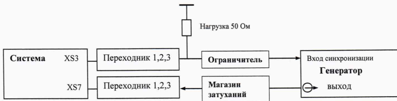
Рисунок 4 – Схема для определения абсолютной погрешности измерений длительности временных интервалов для каналов дифракционного метода
