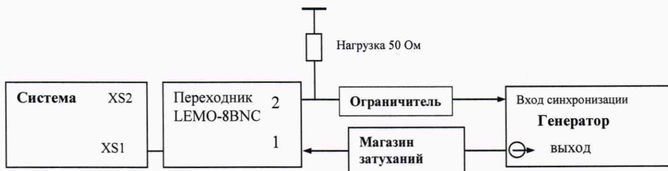
Рисунок 5 – Схема соединения для определения абсолютной погрешности измерений отношений амплитуд сигналов на входе приемника для каналов фазированных решёток
