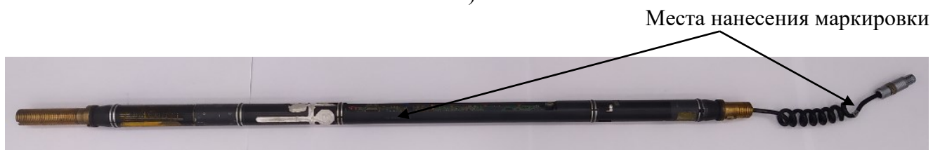
Рисунок 3 – Общий вид инклинометров МИ-501 (а – в немагнитном кожухе, б – без немагнитного кожуха)
