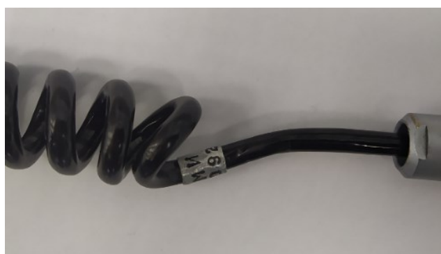
Рисунок 4 – Маркировка инклинометра МИ-501 (а – на корпусе инклинометра, б – на проводе питания)
