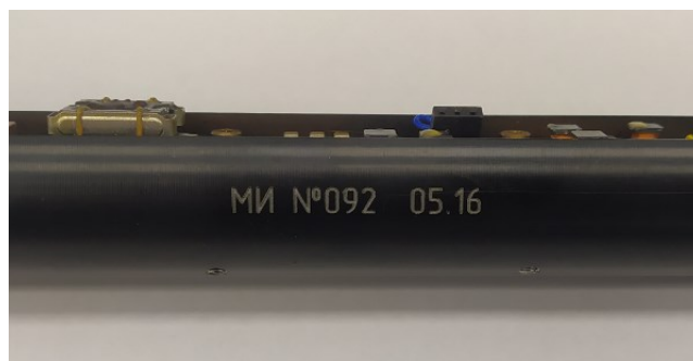
Рисунок 3 – Маркировка инклинометра МД-402 (а – на корпусе инклинометра, б – на проводе питания)
