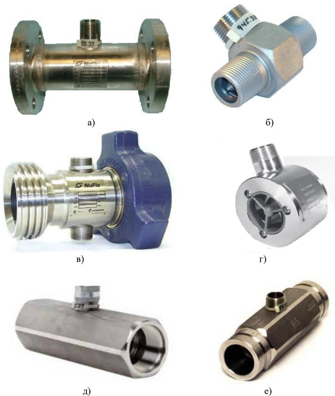
Рисунок 1 – Общий вид первичных преобразователей: а – с фланцевым концевым соединением; б – с резьбовым концевым соединением (наружная резьба); в – с концевым соединением на основе штуцера типа 1502 WECO; г – с концевым соединением EZ-IN (межфланцевое); д – с резьбовым концевым соединением (внутренняя резьба); е – с бессварным концевым соединением Victaulic
