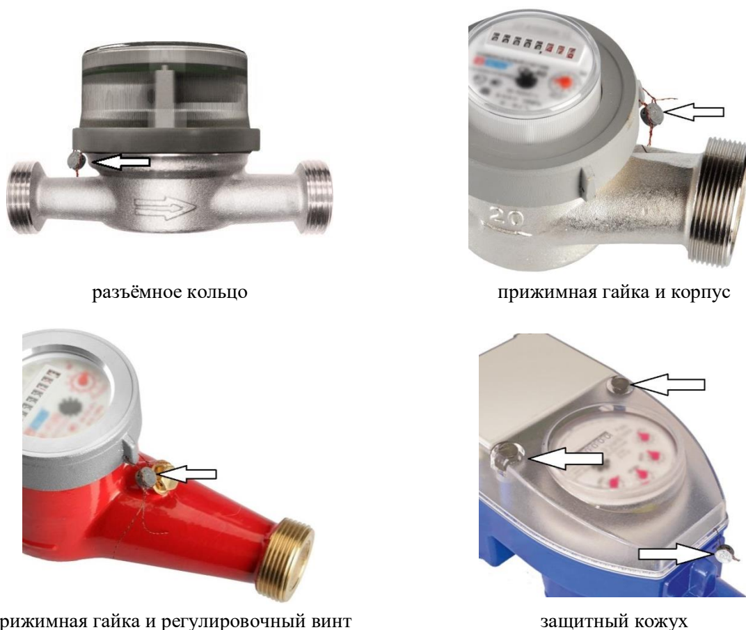
Рисунок 8 – Схема пломбировки от несанкционированного доступа, обозначение места нанесения знака поверки счетчиков показано стрелкой
