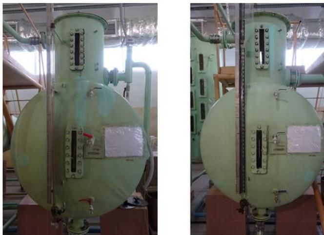
Рисунок 1 - Общий вид мерников Г4-ВИЦ-250, зав.№№ 458, 459
