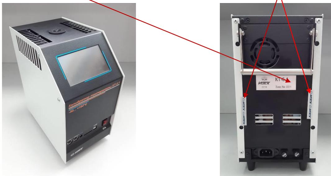
Рисунок 1 - Общий вид калибраторов модификации КТ-6.1
