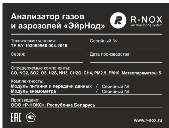
Рисунок 2 – Общий вид идентификационной таблички и место нанесения знака утверждения типа Анализаторов газов и аэрозолей «ЭйрНод» а) Анализатор; б) Модуль питания и передачи данных.
