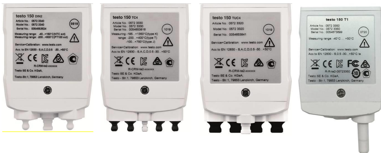
Рисунок 2 – Общий вид электронных блоков (без модулей связи) измерителей комбинированных Testo 150 и место нанесения знака утверждения типа на информационной этикетке, наклеенной на тыльную сторону средства измерений
