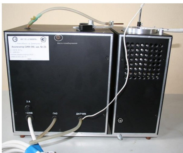
Рисунок 2 – Схема пломбировки от несанкционированного доступа
