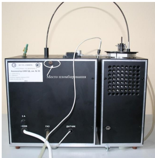
Рисунок 2 – Схема пломбировки от несанкционированного доступа
