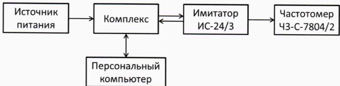
Рисунок 4 – Схема для определения погрешности измерения скорости ТС и рабочей частоты излучения
