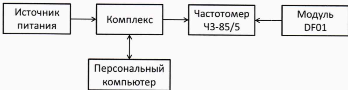
Рисунок 1 – Схема проведения измерений при определении погрешности синхронизации шкалы времени комплекса
