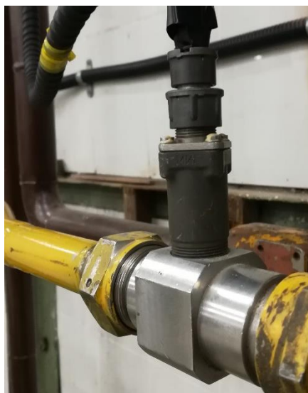
Рисунок 12 – Преобразователь расхода турбинный ТПР12-2-1 (на мерном участке топливной системы стенда)
