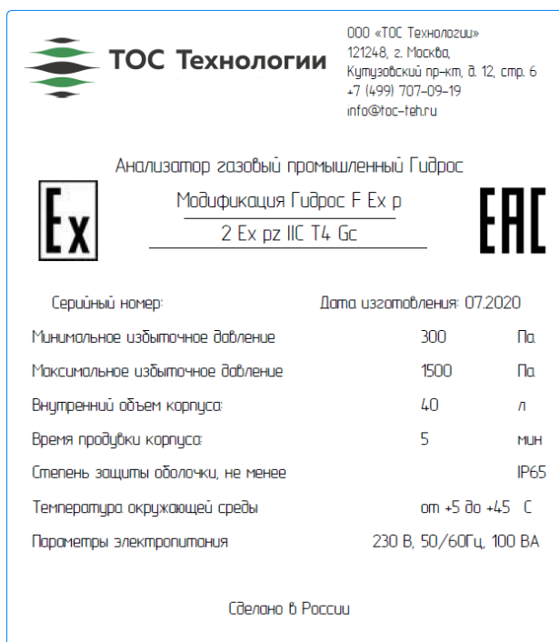
Рисунок 7 – Общий вид идентификационной таблички анализаторов газовых промышленных Гидрос модификации Гидрос F Ex p
